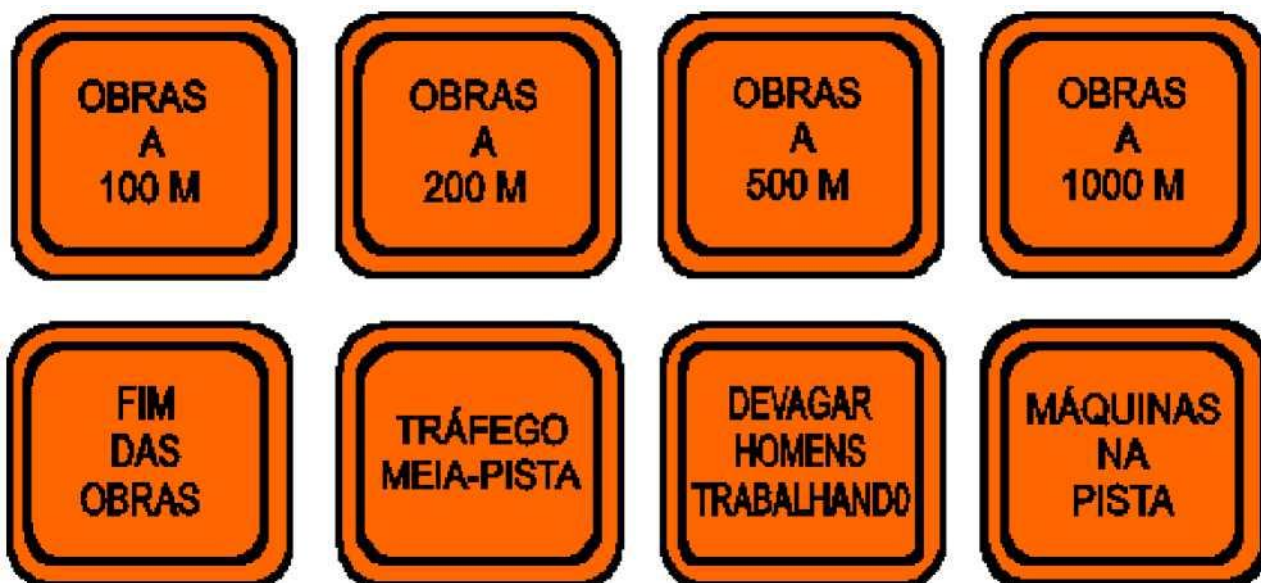
Figura 16 - Modelos de placas de sinalização vertical de obras
